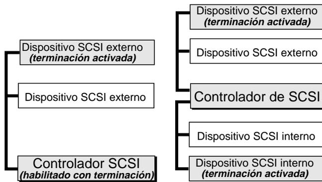
Ejemplo 1: Terminación de SCSI en un sistema que tiene dispositivos SCSI externos solamente.
